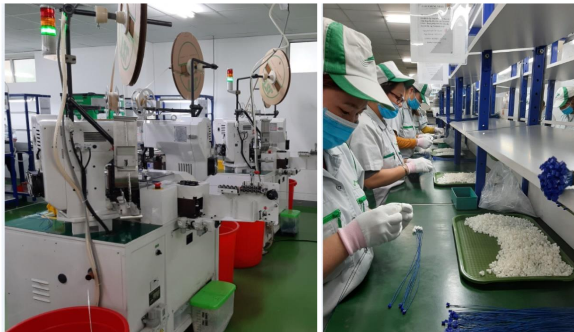
Hình 1. 3. Cắt, quấn và cắm dây điện
