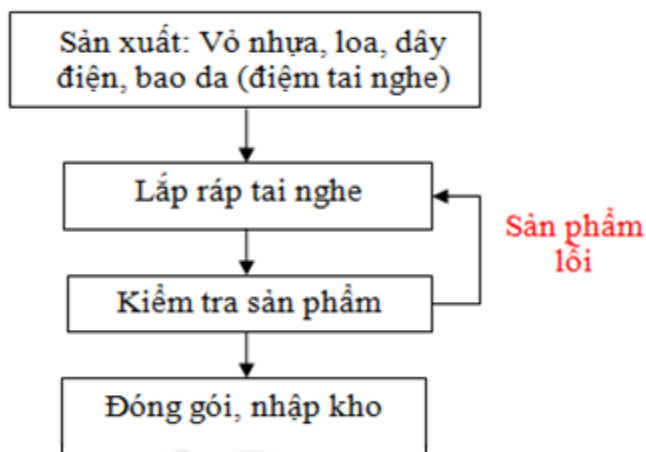
Hình 1.1. Sơ đồ quy trình sản xuất, lắp ráp sản phẩm tai nghe
