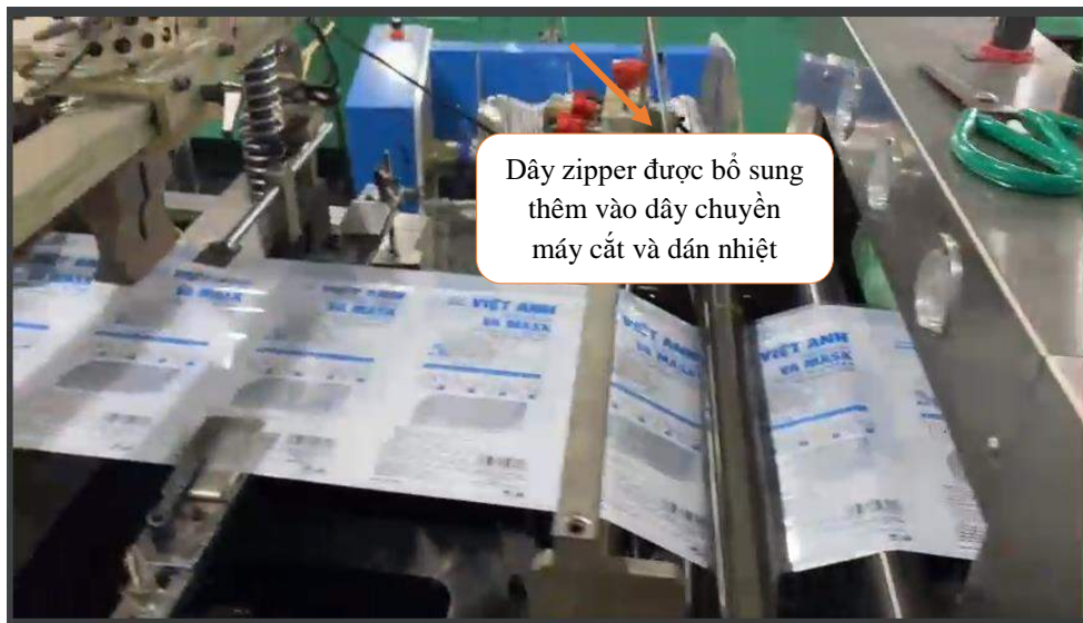
Hình 1.9. Hình ảnh dây zipper được thêm vào dây chuyền máy cắt và dán nhiệt
