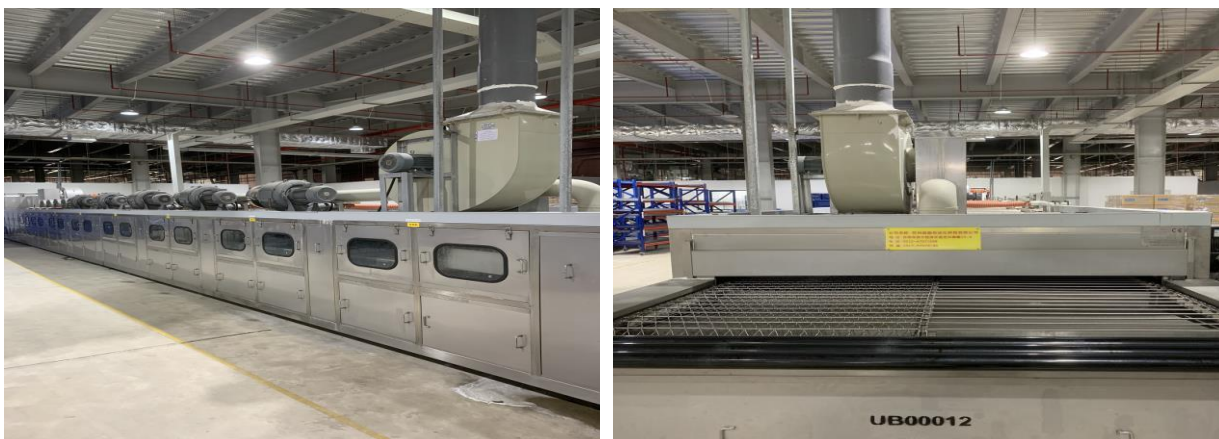
Hình 1. 13. Dây chuyền tẩy rửa đang hoạt động của nhà máy
