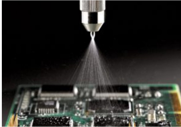
Hình ảnh phun sơn UV bảo vệ bản mạch
