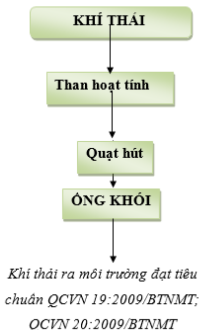
Hình 4.4. Quy trình công nghệ của hệ thống xử lý khí thải
